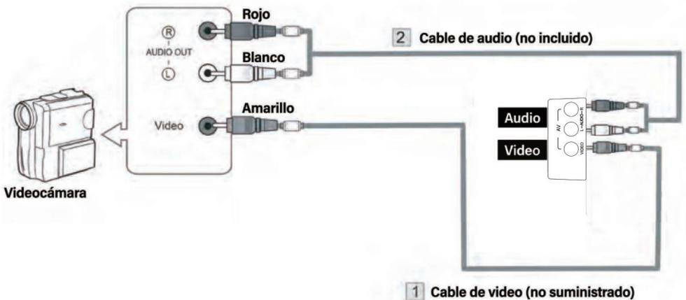
1. Conecte un cable de video entre las tomas de entrada AV VIDEO del televisor y la toma de salida de video de la videocámara.
