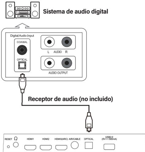
El audio de 5.1 canales es posible cuando el televisor está conectado a un dispositivo externo que admite 5.1 canales.
